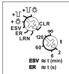
**L'interrupteur rotatif supérieur,** dans la position LRN, permet de programmer jusque 35 émetteurs radio bouton-poussoir, donc un ou plusieurs boutons-poussoirs pour commande centralisée. Egalement des contacts porte / fenêtre avec la fonction NO ou NF en cas de fenêtre ouverte, des détecteurs radio de luminosité pour montage extérieur FAH et détecteur radio de mouvement FBH. Ensuite il permet de sélectionner la fonction désirée du relais télérupteur :
