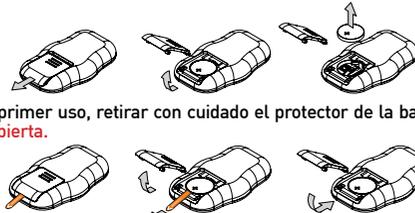
Antes del primer uso, retirar con cuidado el protector de la batería, después de abrir la cubierta.
