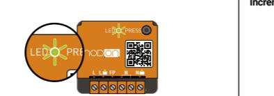
3 La LED du module scintille 2 fois en vert, confirmant l'appairage des deux appareils.
