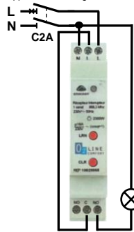
Schéma de raccordement pour application éclairage ≤ 400W :
