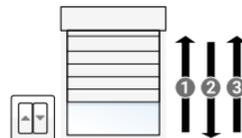
2 Le volet roulant ou le store effectue un cycle "montée/descente/montée"
