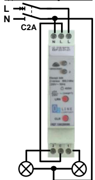
Schéma de raccordement pour application éclairage ≤ 400W :
