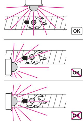
Damit das Einschalten des angeschlossenen Verbrauchers durch Umwelteinflüsse vermieden wird, sollten Sie den ARGUS so montieren, dass er vor Regen und direkter Sonneneinstrahlung geschützt ist. Beispielsweise kann ein Regentropfen, der über die Linse läuft, den Bewegungsmelder einschalten.
